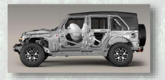
La seguridad y protección para los pasajeros presenta más de 75 componentes de seguridad activa y pasiva disponibles. Entre ellos se incluyen: monitoreo de punto ciego, control de tráfico cruzado, cámara trasera ParkView con líneas de cuadrícula dinámicas, control electrónico de estabilidad (ESC, por sus siglas en inglés) con mitigación electrónica antivuelco y cuatro AirBags de serie.
