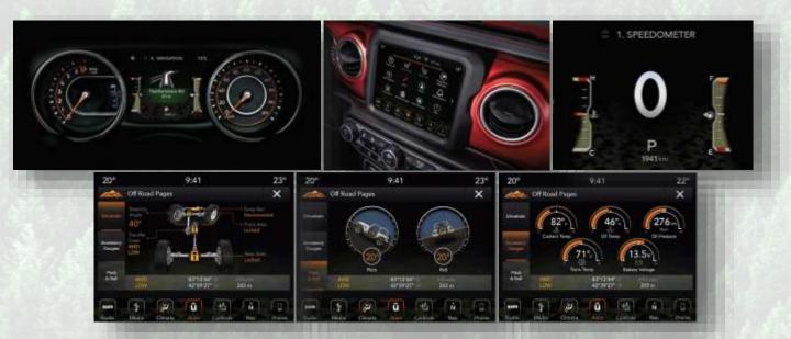
El nuevo Wrangler JL incorpora la 4ta generación del sistema Uconnect con display digital de 8,4" con funciones de comunicación, entretenimiento y navegación. A partir de esta generación, se suma la aplicación "Off-Road Pages" que permite al usuario estar informado en relación a la articulación de las ruedas, temperatura de la transmisión, datos de inclinación, información de la suspensión y modos de conducción entre otros.
