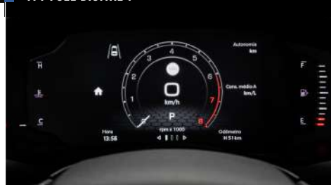
CUADRO DE INSTRUMENTOS TFT FULL DIGITAL 7"
